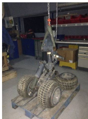
Train d'atterrissage "tout terrain" du SA 330 "Puma"
