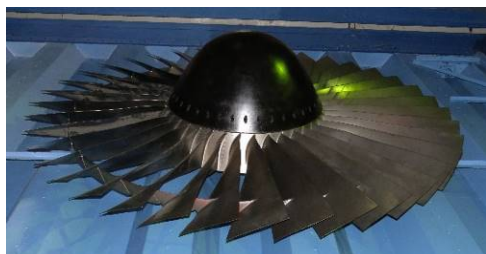
Soufflante du General Electric CF6-50
