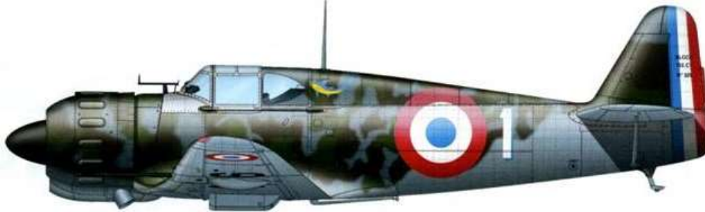
Bloch MB-152 C1 n° 389 du GC II/8 (Juin 1940). Le moteur 14N marque la naissance du concept du groupe motopropulseur (GMP), intégrant à la fois le moteur, les équipements, les câblages, les tuyauteries, les capots et les fixations, jusqu'à la cloison pare-feu qui devient de la responsabilité de l'avionneur et non plus du motoriste.
