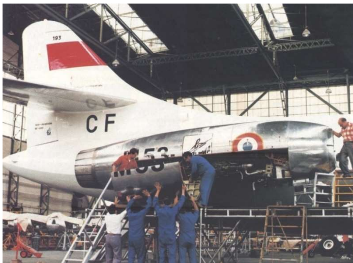
Installation du turbofan M53-2. La nacelle droite avait un diamètre de 1 m 66.
