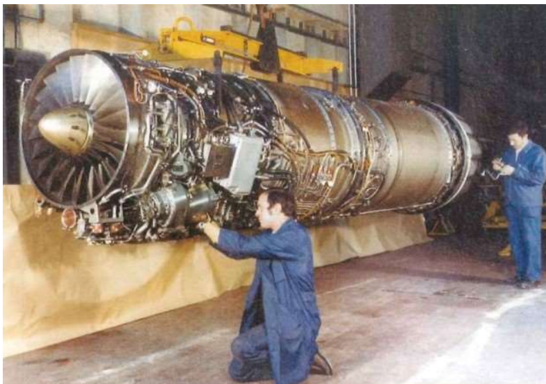
Préparation d'un M53-2. Dans les faits, la seule application de ce moteur à double flux à un seul corps - une configuration atypique - fut le Mirage 2000 de Dassault.
