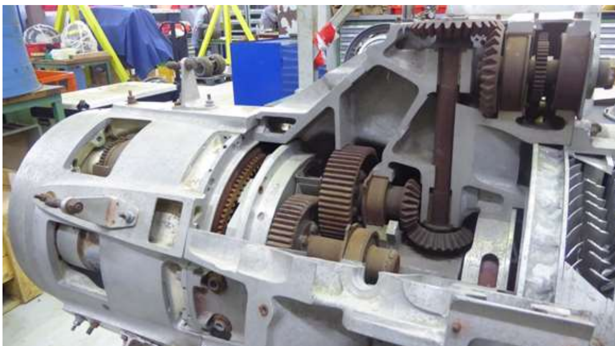
Système d'entraînement des divers accessoires et premier étage fixe et mobile du compresseur axial
