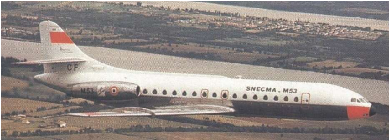
La SE 210-308 Caravelle III n° 193 (immatriculée F-ZACF) avec un moteur M53-2 de 8 500 kgp avec postcombustion.
