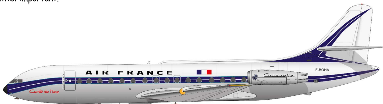
SE 210 Caravelle III aux couleurs d'Air France. C'est au cours du développement que, pour éviter l'absorption de cors étrangers, les entrées d'air furent légèrement orientées vers le haut et l'intérieur.
