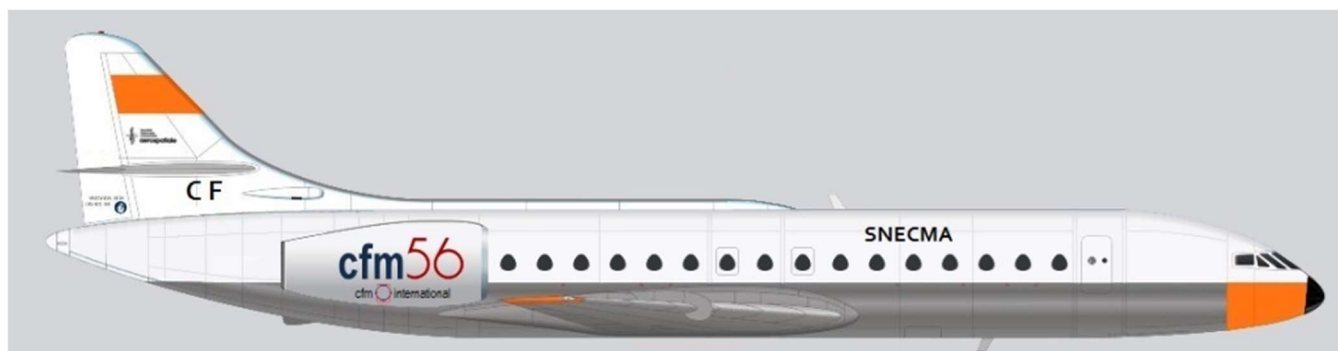
La Caravelle III n° 193, codée CF pour Charlie Foxtrot, banc d'essais volant du CFM56 (1978).
