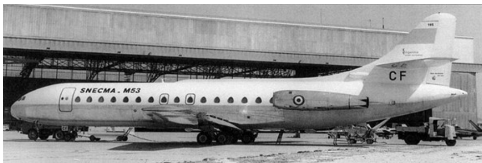
La Caravelle III n° 193 banc d'essais volant du moteur M53-2 (1973 - 1975)
