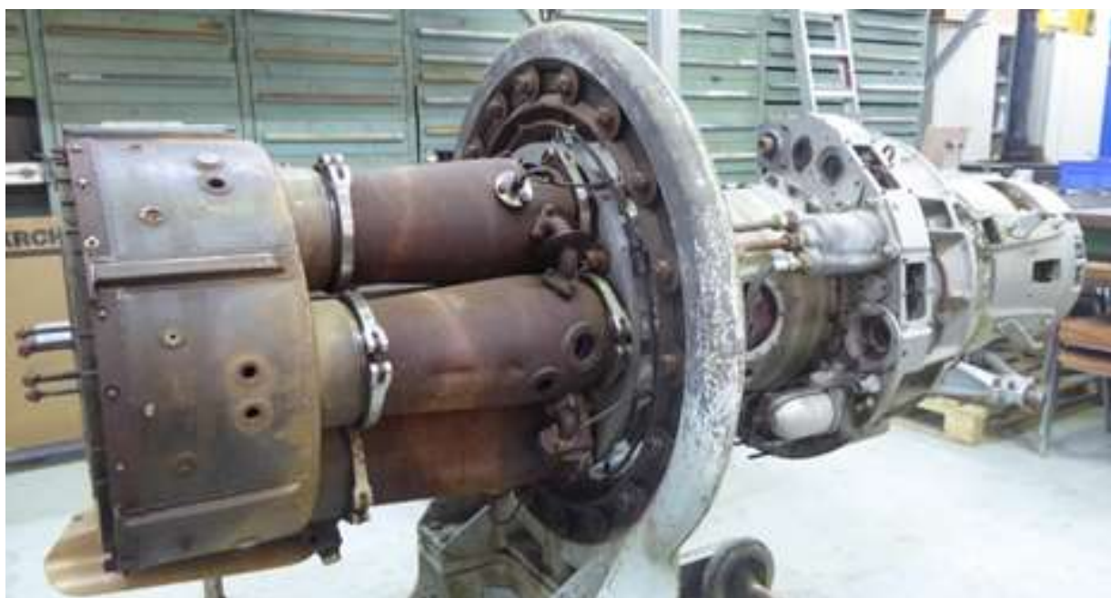
Vue arrière du carter externe de turbine et de la chambre de combustion à 6 tubes à flamme - 27/02/2019
