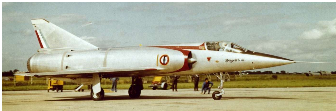
Mirage III T 01 propulsé par un TF-106 au roulage à Melun-Villaroche. La chambre réacteur est ventilée par des écopés. (Copyright Dassault Aviation)
