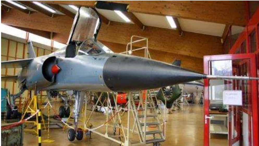
Mirage F-1 E01 / M53 à Latresne (Copyright Aérocampus d'Aquitaine). Près du train principal gauche se trouve l'éolienne de secours. Grâce au vent relatif du déplacement de l'avion, cette éolienne fournit une énergie minimale permettant d'alimenter les équipements essentiels de l'appareil (les commandes de vol entre autres) et ce, pour une durée illimitée.
