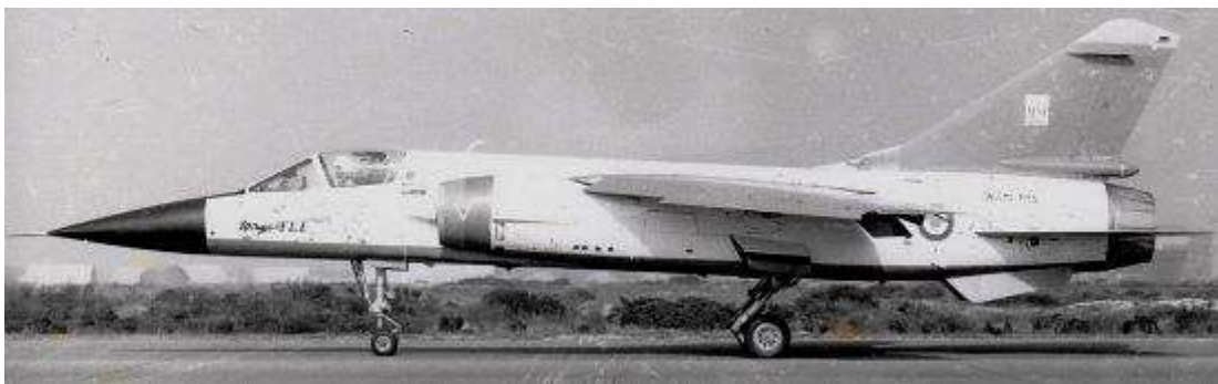
Mirage F-1 E01 / M53 avec entrées d'air à bord épais (1980) (Copyright Espace Patrimoine Safran)
