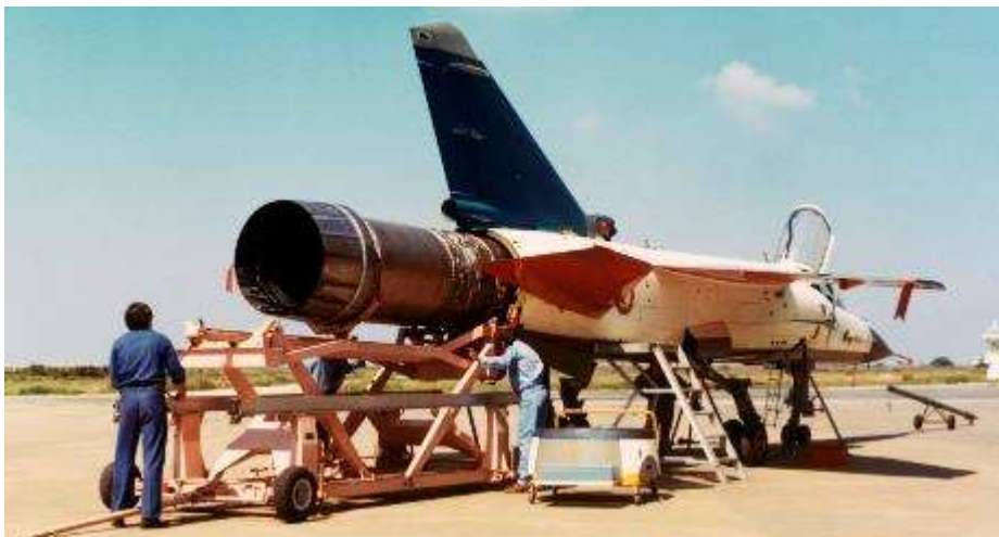
Avionnage du moteur M53-02 n°221 sur le Mirage F-1 E01 (Copyright Espace Patrimoine Safran)
