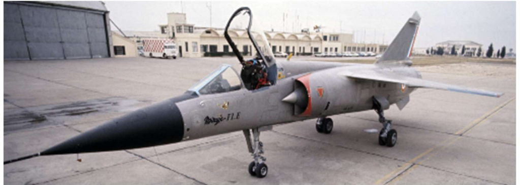
Mirage F-1 E 01. La partie avant comporte de nombreuses sondes de mesures aérodynamiques (Copyright Dassault Aviation)
