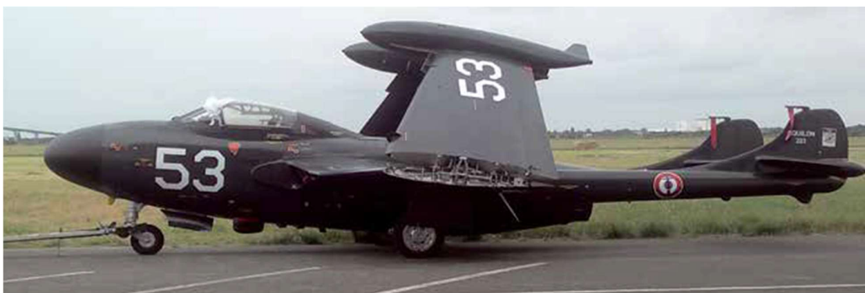
Sud-Est SE-203 " Aquilon " n° 53 Flottille 16F (Copyright ANAMAN). De construction mixte (bois et métal), il est doté d'un siège éjectable SNCASO E-92, d'une verrière coulissante bilobée et d'ailes repliables.
