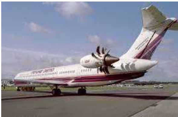
Installation du "démonstrateur" UDF de GE sur un Douglas DC-9 (Mai 1987)
